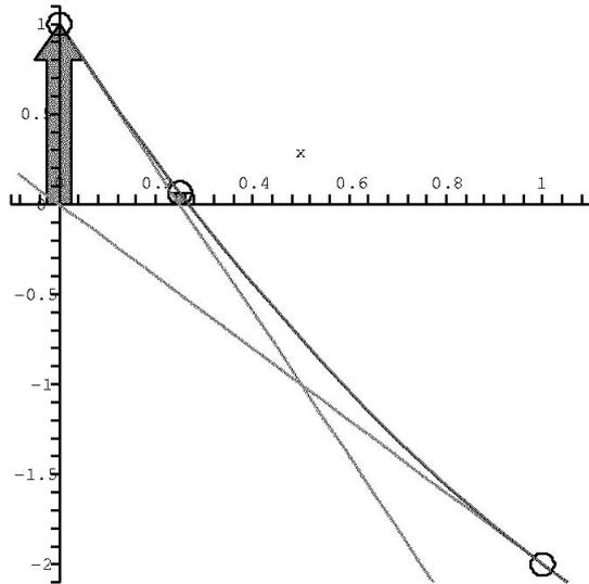
図 2: ニュートン法の原理の模式図.
