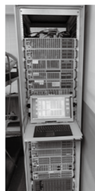
図1 計算クラスター、CPUはIntel Xeon Goldなどで全360 coresでの並列計算が可能
