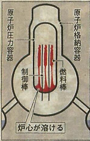
燃料棒が溶けて破損する事故。原子炉の冷却水が失われ水位が下がり、燃料棒が露出すると燃料棒中の放射性物質の熱が除去されず、溶け始める。これが致命的となった。
