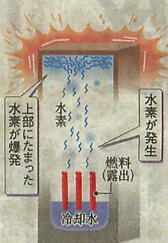
炉心温度が上がりすぎ燃料棒が溶けるなどの状態になると、燃料を覆う被覆管の金属シリコニウムと水蒸気が化学反応し、水素ガスが発生。何らかのきっかけで爆発する。1、3号機では水素ガスが建屋にたまり爆発したとみられ、4号機でも水素爆発が起きた可能性がある。
