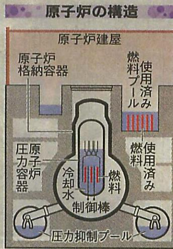
炉心に制御棒を挿入して核分裂反応の連鎖を止め、原子炉を常温・常圧の安定状態にする。震災では電源が喪失して冷却できなくなり、炉心溶融や水素爆発が発生。原子炉を冷温停止するため、電力を復活させる作業が進む。
