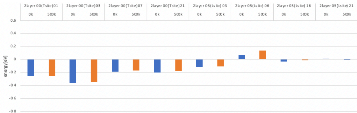
図 3.3: 添加元素が Zn の時の 20 21 site を基準とした total energy の差.
