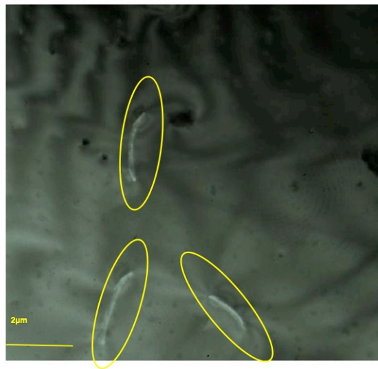
図 3.1: 確認された Cu 析出物 [16].
