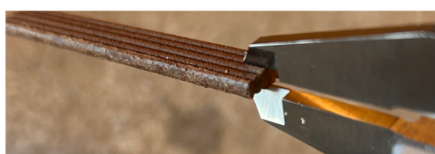
Figure 4 ノッチ間寸法の測定
