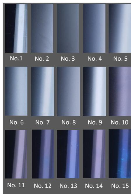
図1 保護フィルムを貼り付けたスマートフォンの表示面 (No.1はフィルム無し)
