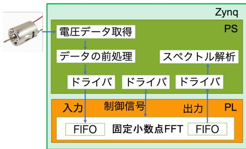
図 7: プログラマブル SoC による実装
