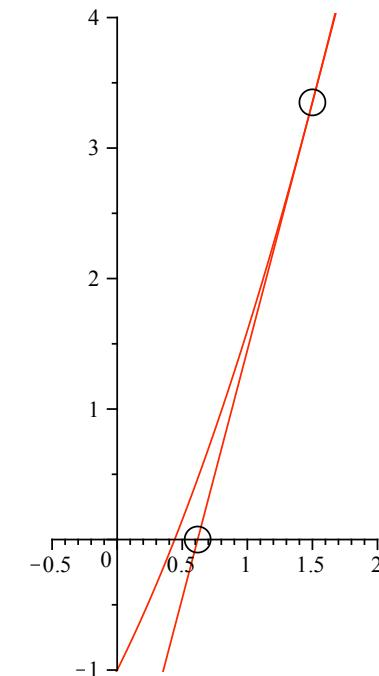
現実には高次項の影響で計算通りにはいかず、単に最小値の近似値を求めるだけである。これは、 $\chi^2(\mathbf{a})$ の微分関数の解をNewton法で求める操作に対応する。つまり、この操作を何度も繰り返せばいずれ解がある精度で求まるはず。
