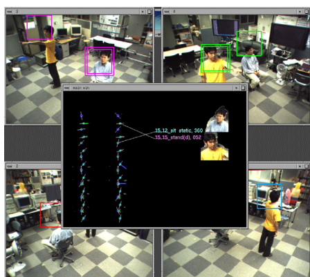
図 6.3 個人識別機能を有するヒューマンインタフェース（人間の立体的な形によって体の向きや腕さし動作を認識。同時に、個々の人物毎に最も正面に近い顔画像が自動的に選ばれ、それを使って顔認識が行われる。）
